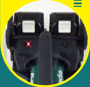
切れたバッテリーLを予備バッテリーと交換すれば、バッテリーRが切れた時、再びバッテリーLへ切替ります。
